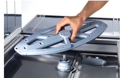
Retirar ambos os braços aspersores da máquina
