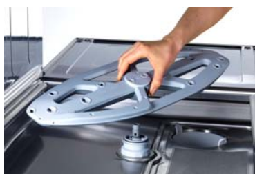
Założyć oba obrotowe pola splukiwania. Mają one identyczną budowę i mogą być założone zarówno na dole jak i na górze. Po ich założeniu należy sprawdzić czy mogą się swobodnie obracać.
