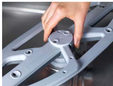
Unteres Drehspülfeld entriegeln
