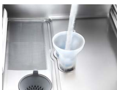
Trichter in die Einfüllöffnung des Salzbehälters setzen und nach und nach 3 Beutel Winterhalter-Spezialsalz (=1,5kg) einfüllen. Trichter abnehmen und den Einfüllbereich von Salzresten säubern
